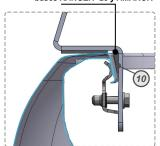
COLOCAR ARCO DELANTERO, AJUSTANDO CON CLAMP.
