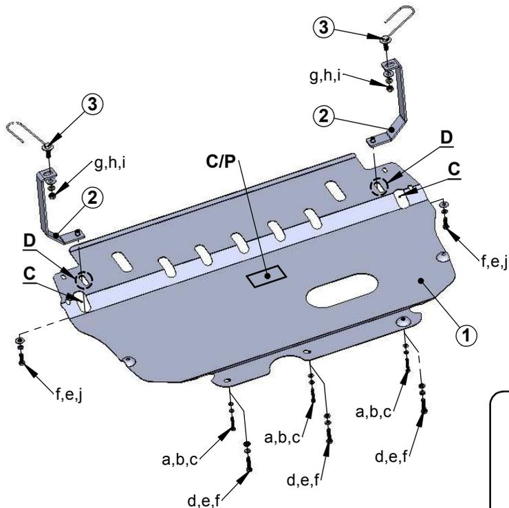
**Atención:** Verificar que los soportes no rocen ninguna parte móvil del vehículo (manguera, soporte, etc)
